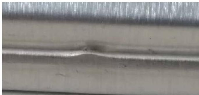
这是一个示例图像, 显示了我们的在线卷封检测装置如何检查矩形食品罐 (其中包括鱼罐)。
