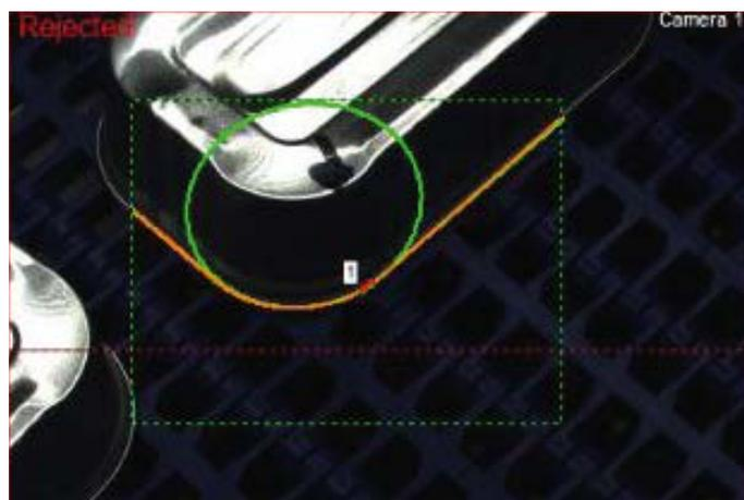
婴儿配方奶粉罐的示例图像，包括操作员视图和卷封不良的实际罐。
