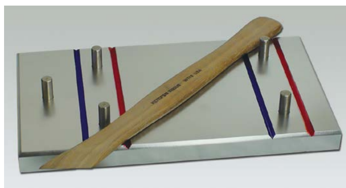
包括用于准备划车测试样品的刻划装置
