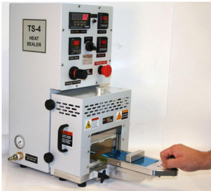
带有可选手动滑动托盘的TS-4热封仪
