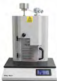
MFR 300 采用光学旋转编码器 配备最新的 Techni-Test 软件
