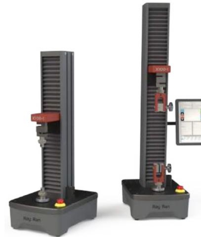
此外，拉伸强度也是密封袋重要检测项目。为了确保密封袋的抗拉性，需要针对包装材料在拉伸载荷作用方面进行一系列试验。这一试验一般是在拉力试验机上进行。
