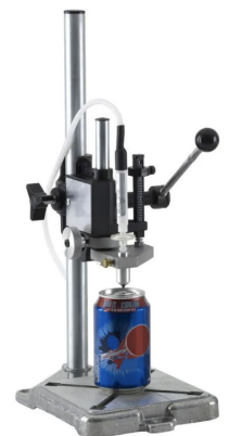
微量顶空分析仪及铝罐夹具
