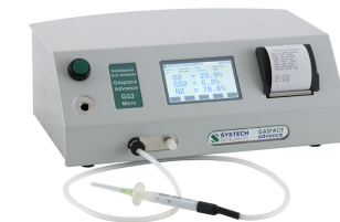
微量顶空分析仪及铝罐夹具
